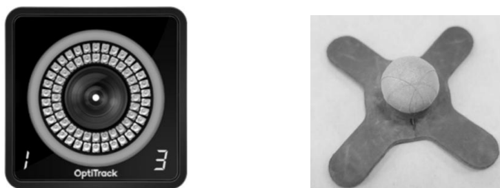
Рис. 4.1. Камера захвата движения Prime13 и маркеры (mark).
