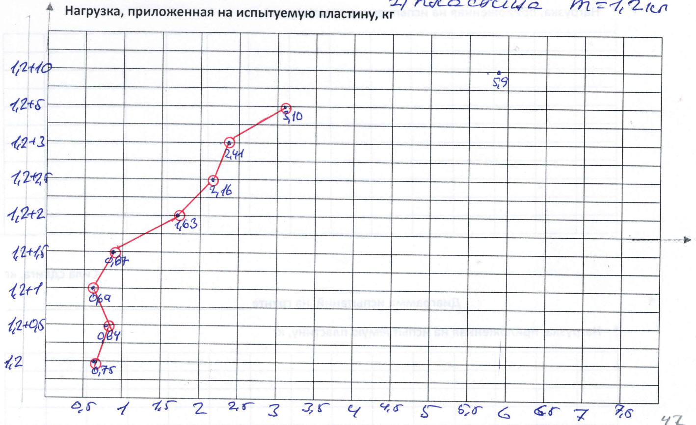
Диаграмма испытаний на грунте супесь Исаев-Куль 3) пластина поперечная высотой 20 мм m=1,25 кг
