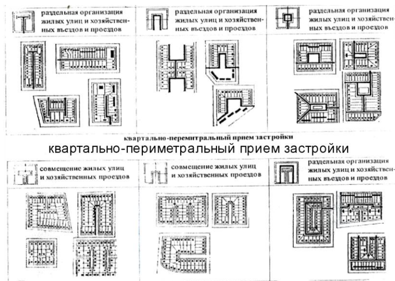
Рис.8. Архитектурно - планировочная организация усадебной квартальной и внутриквартальной застройки одно- и двухквартирными жилыми домами
