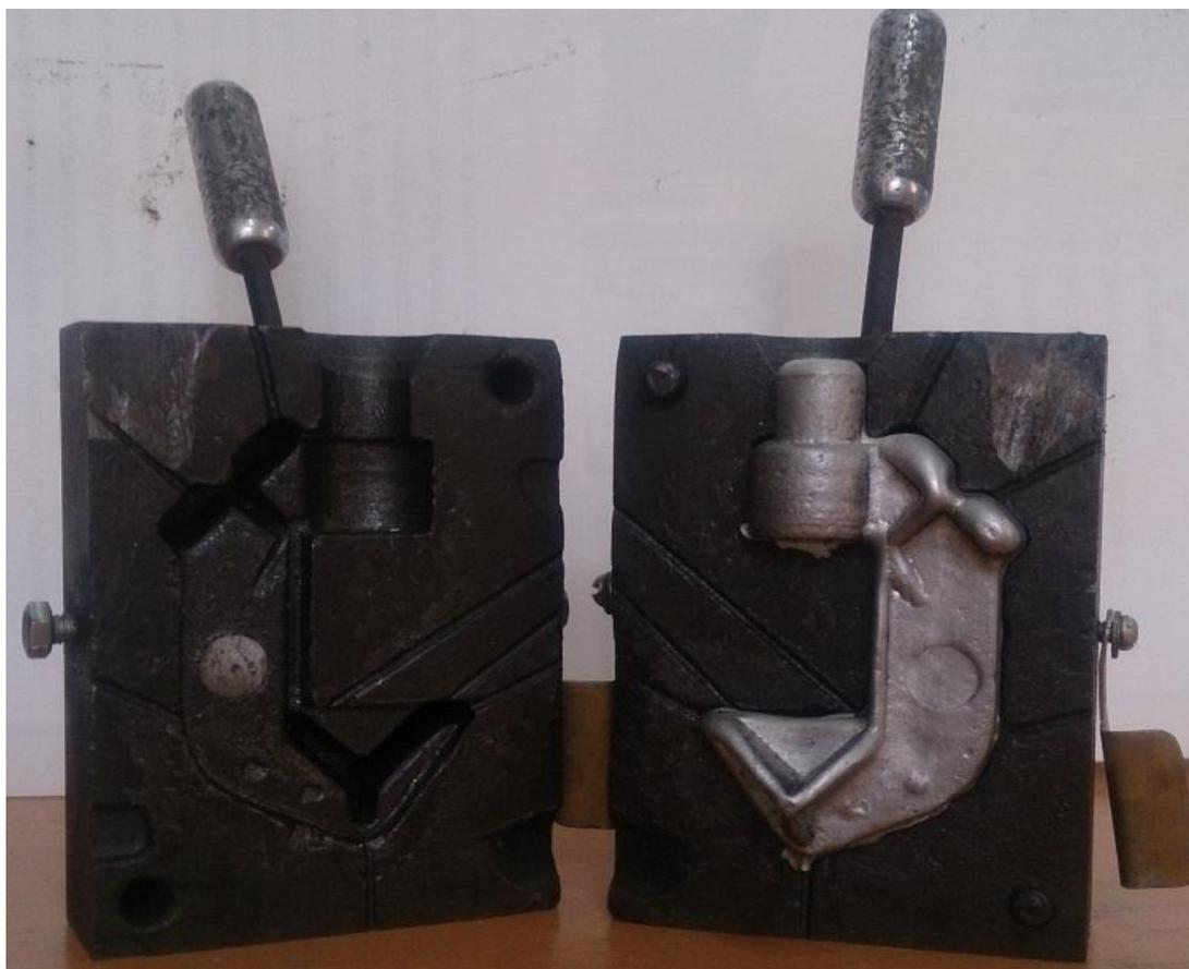
Рис.4. Лабораторно-промышленная установка литья в кокиль.
