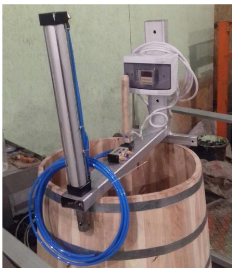
Рисунок 19 – Пневматическая установка работающая на сжатом воздухе
