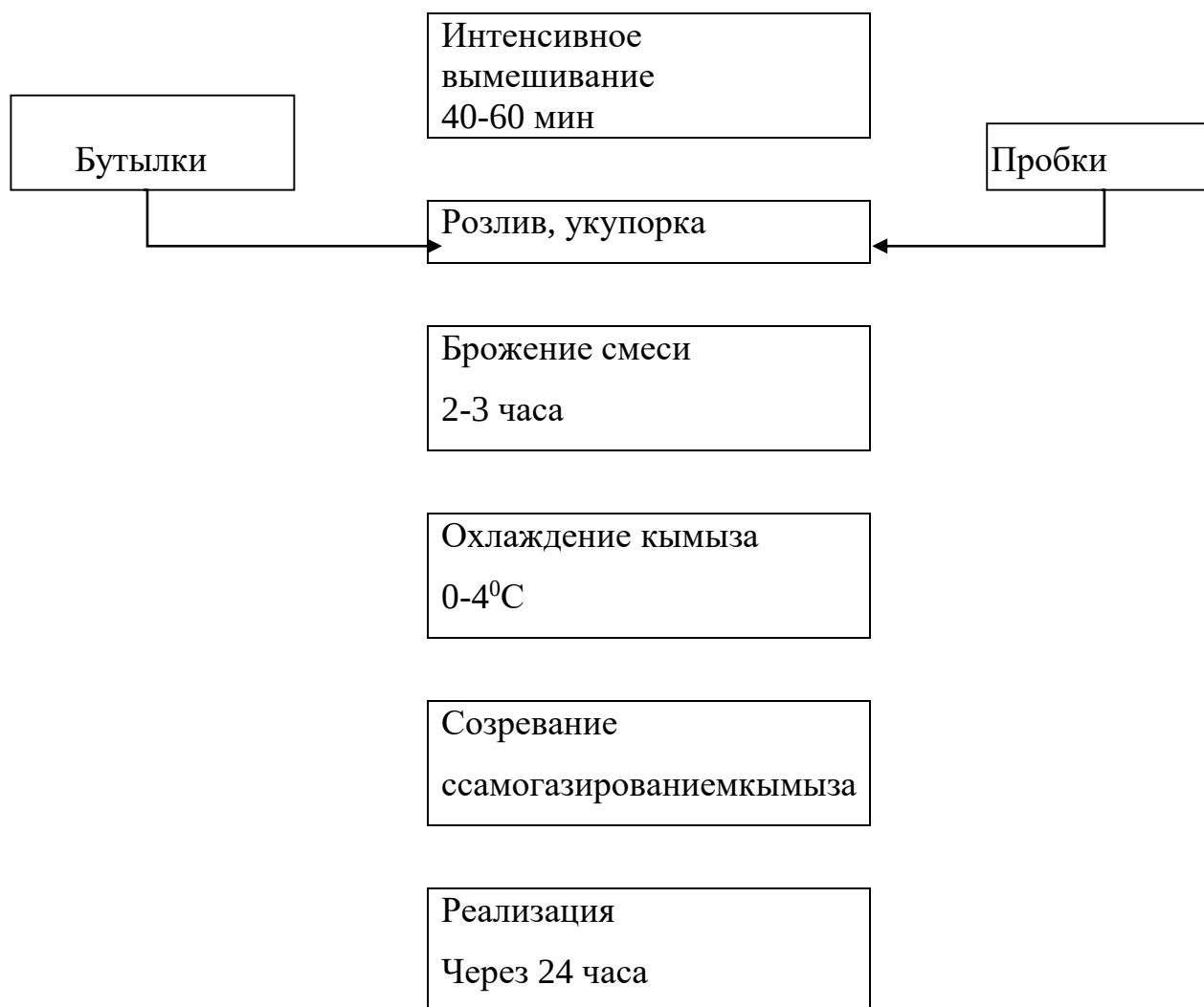
Рисунок 2 – Технологическая схема по ускоренному способу приготовления кымыза
