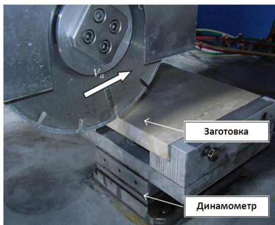
Рис.1.13 Динамометр для измерения сил резания P_z , P_v , P_m .
