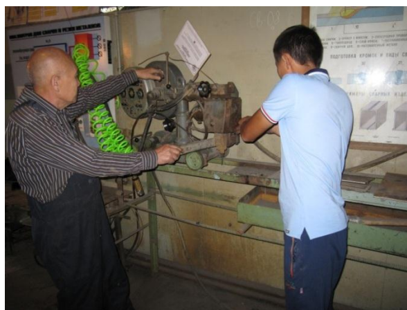
Ремонт систему перемещения и подъема плазмоторна
