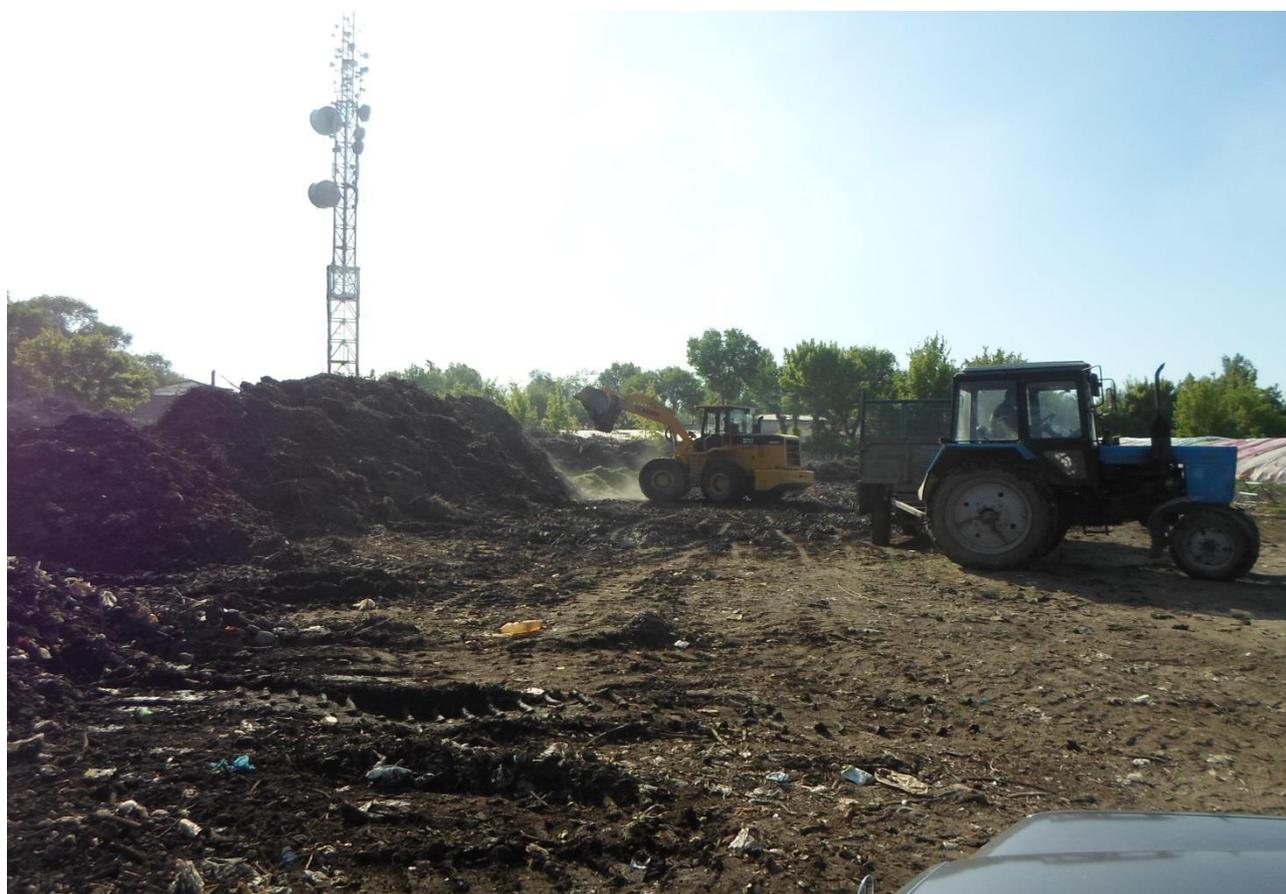
Рис.3.3. Перелопачивание компоста для улучшения аэрирования
