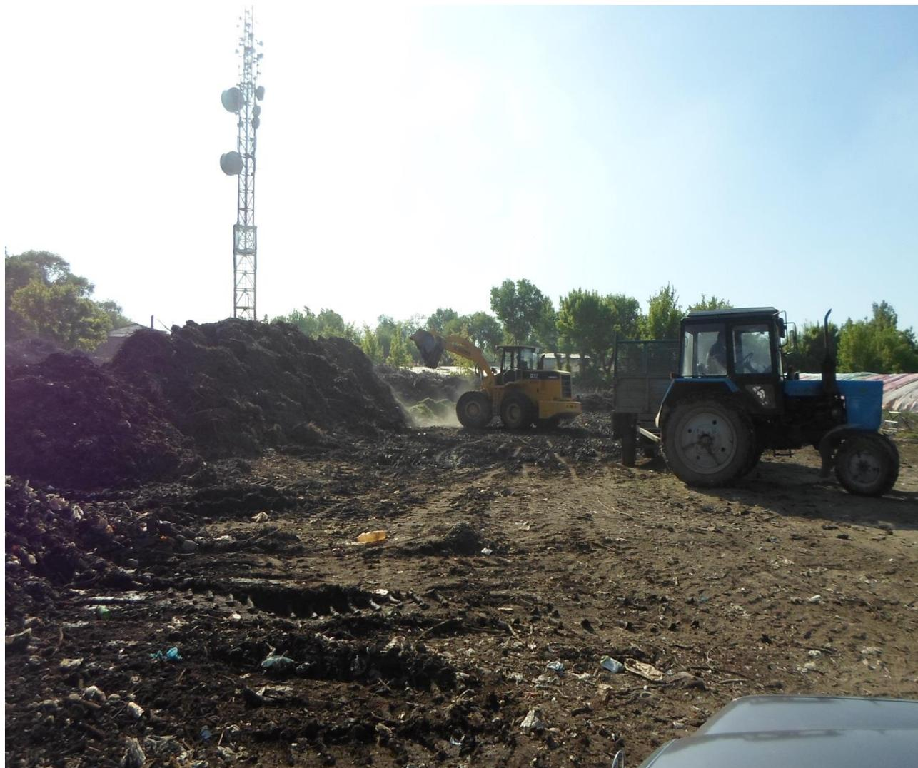
Рис. 3.5. Штаблеукладчик, оборудованный ковшем объемом 2 м<sup>3</sup> для периодического перемешивания компоста
