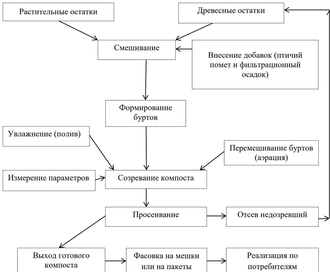
Рис.3.4. Технологическая схема получения органоминерального удобрения из древесно-растительных отходов городского лесопаркового хозяйства
