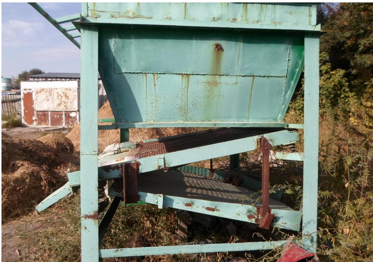
Рис.3.6. Вибросито трехступенчатое для фракционирования готового компоста.
