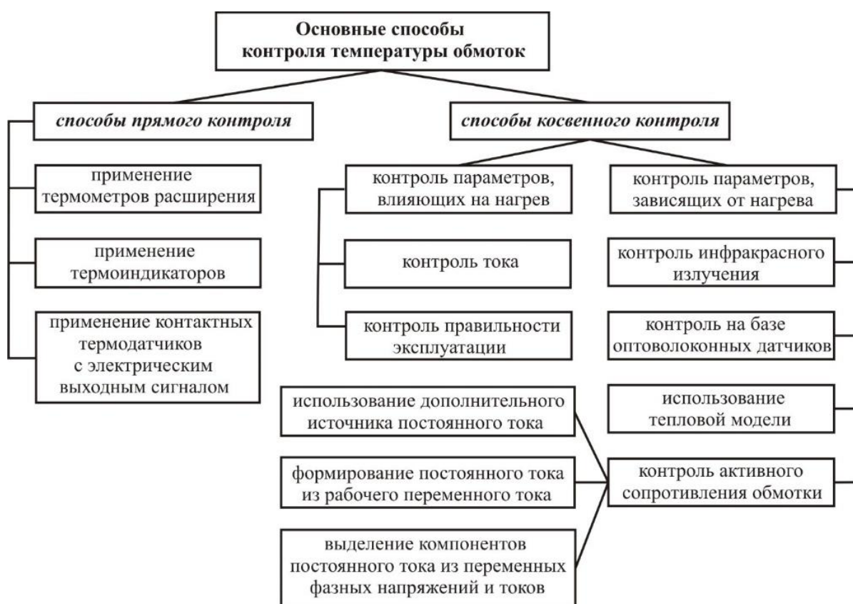
Рис. 2.1. Общая классификация основных способов теплового контроля обмоток
