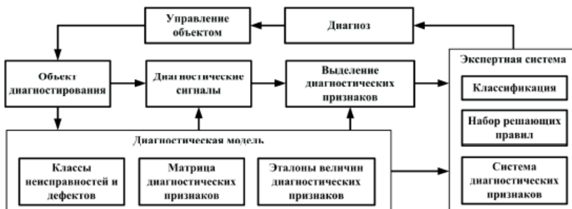
Рис. 1.6. Структурная блок-схема алгоритма технического диагностирования
