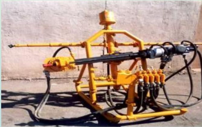
**Станок для веерного бурения
