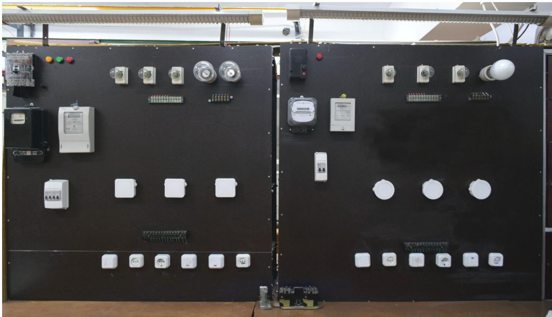
Стенд. Исследование влияния качества напряжения на работу осветительных установок 5/2036.
