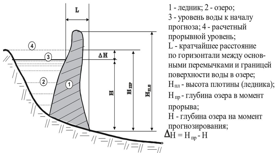
Рис. 1. Расчетная схема прорывного селя
