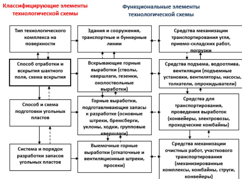
Рис 4. Блок-схема основных элементов технологической схемы шахты: сплошные стрелки - жесткие связи; пунктирные - связи, учитывающие некоторое влияние на выбор решений
