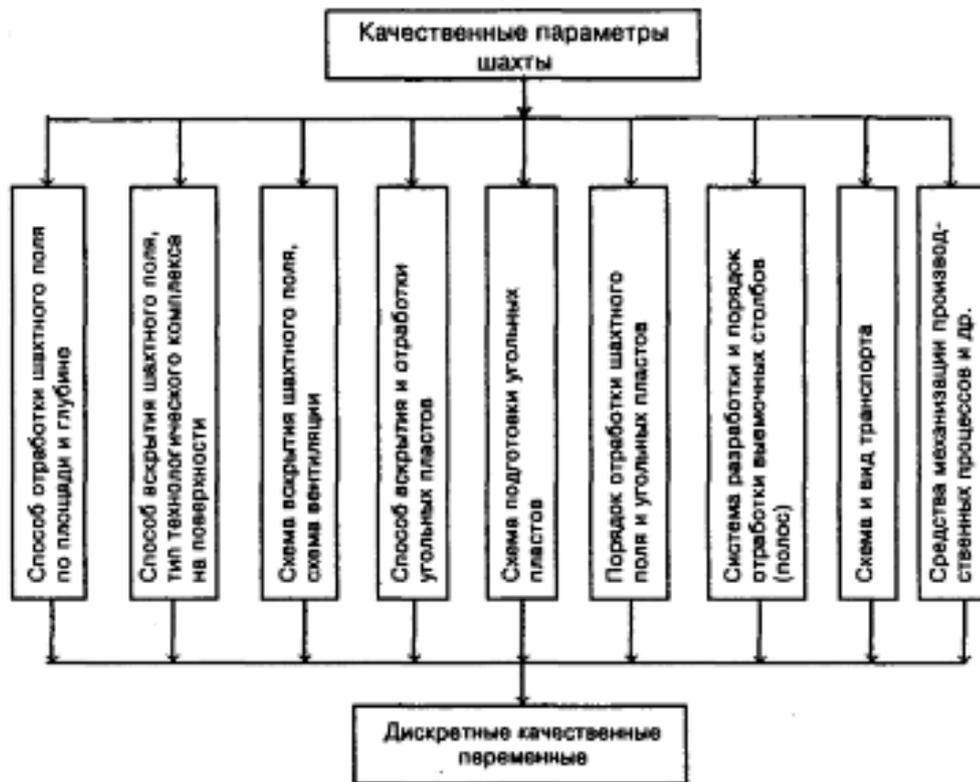
Рис. 3.1. Блок-схема качественных параметров шахт
