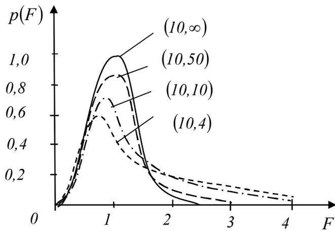
Рис. 3.3.  $F$ -распределение для различных  $f_1$  и  $f_2$
