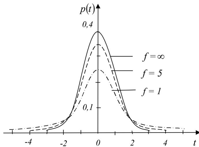
Рис. 3.4. Кривые плотности  $t$ -распределения
