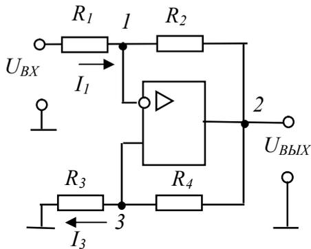
Рис. 7.1. Усилитель с отрицательной и положительной обратными связями
