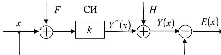
Рис. 2.2. Структурная схема формирования результата и погрешности измерения
