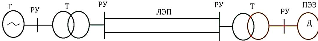
Рис.4.1. Схема простейшей электрической системы
